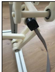
Fig. 8. Maxon HEDL-5540 encoder
